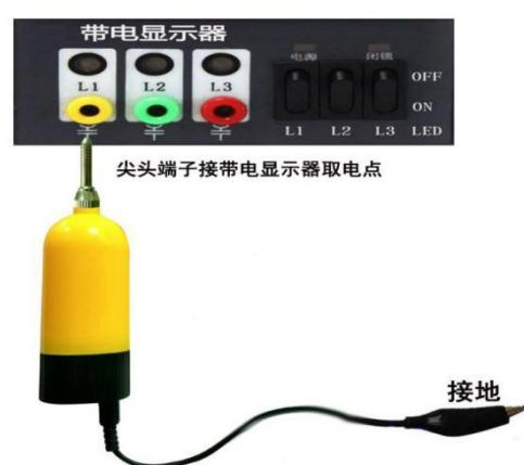
**提示：**由于带电显示器的主要作用是显示开关柜是否带电，并非标准的核相点，且不同厂家、不同时期、不同标准的带电显示器会产生不同程度的移相问题，且带电显示器 L1、L2、L3 与母线的对应关系不一定正确，若核相结果异常则应在一次线路上进行复核，并以一次为准。
