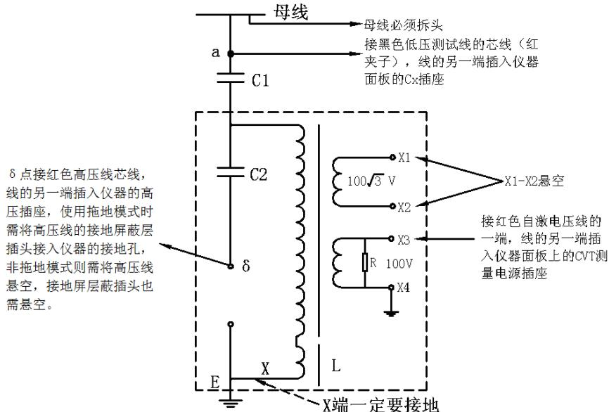
图 5-6 C1 和 C2 的测量方法（选择内标准、CVT 自激法、2kV 测试电压）
