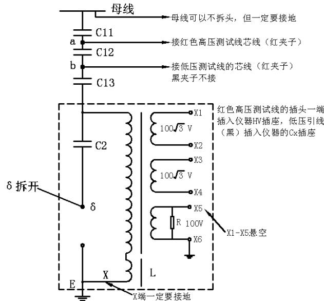
图 5-2 C12 的测量方法（选择内标准、正接线、10kV 测试电压）
