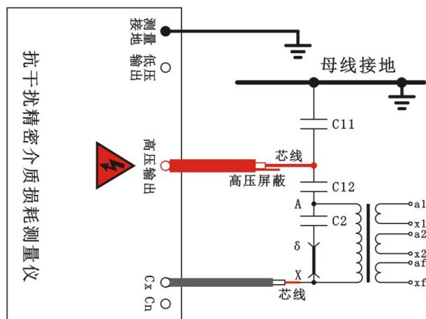
图 4-9 反接线低压屏蔽（D、E、F、S、J型有此功能）
