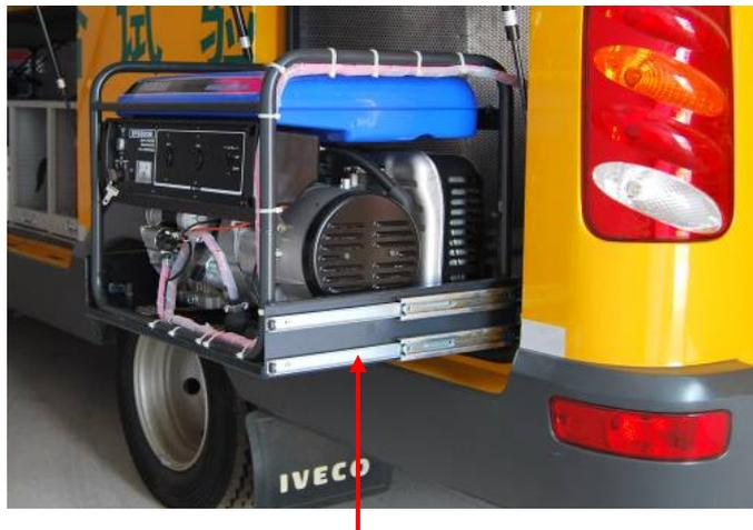
向上提起锁扣转动 180°即可轻松将发电机拉出车外。采用双层重型减振导轨，可承载 150Kg，确保可靠、牢固，同时减少工作时对车的振动。
