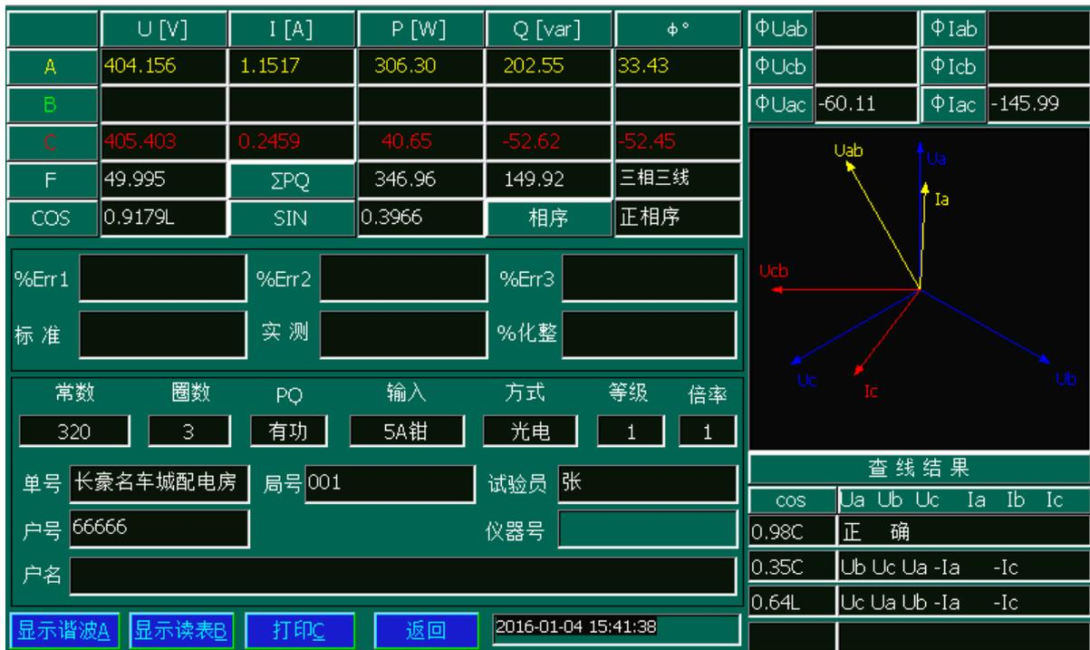
3.按“1”则以图表显示谐波并可打印，再按“2”显示多功能费率数据并可打印。按 3 进行当前界面放大或原样打印切换设置。按“取消”退回查询屏。
