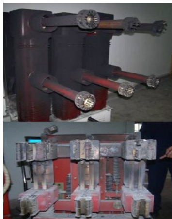
烧毁的开关柜铜排照片
