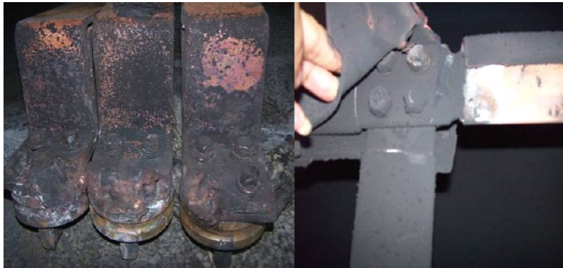
烧毁的开关柜铜排照片
