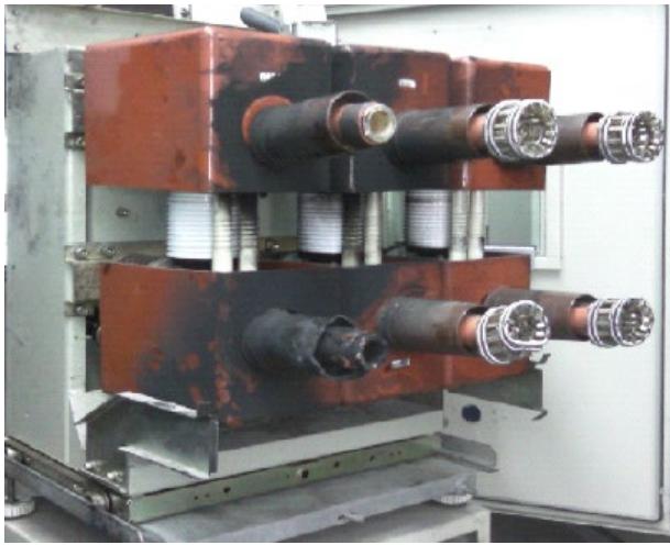
烧毁的开关柜断路器触头
