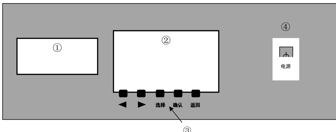
① 热敏打印机--打印测试结果
