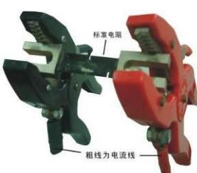
其中标准电阻为 75A, 1mΩ 左右。可以用来检测仪器的基本功能。标准电阻和测试线按下图连接。需要注意：测试线的夹子夹住标准电阻时，电流线必须同时向上或向下。
