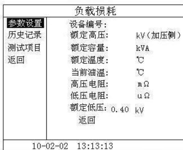
在测试之前，首先要进行相关的参数设置。在上图中光标指向“参数设置”项，此时按键盘上的“确认”键进入右边的参数设置，“↑”、“↓”键选择待修改的项，再按“确认”键进入待修改项的输入项，“←”、“→”键选择输入位置；
