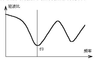
线路短路故障时驻波比与频率的关系见下图:
