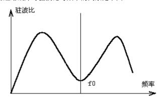
图中 f0 为第一驻波点的频率,在"分析"功能状态下通过"左移"键或"右移"键移动标识线,反复在第一驻波点附近调整,观察显示屏下方 A 的值(驻波比)变化,找出最低点。此时显示出的距离 L 为故障距离, f 为第一驻波点的频率, A 为驻波比。
