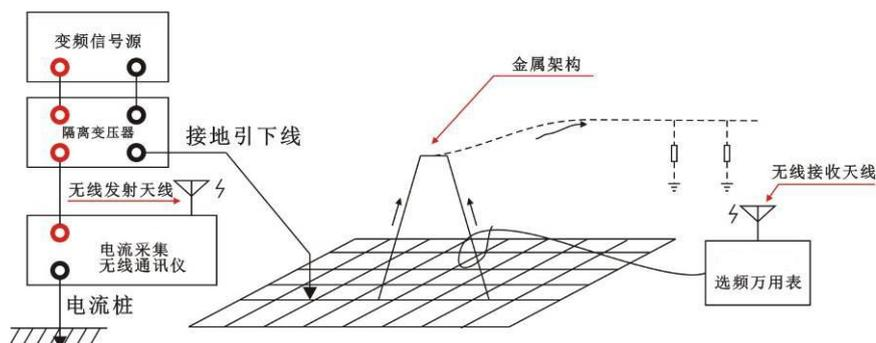
图 4-6 分流向量测试接线示意图
