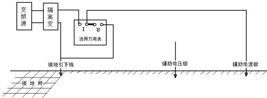
图 4-8 电流桩电阻测试示意图
