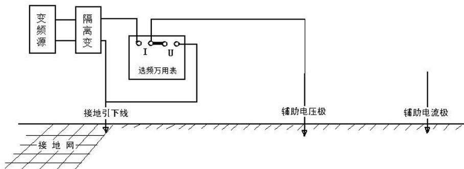
图 4-9 电压桩电阻测试示意图
