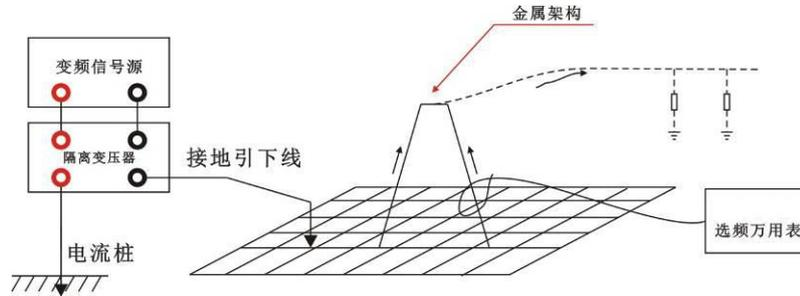
图 4-7 分流有效值测试接线示意图
