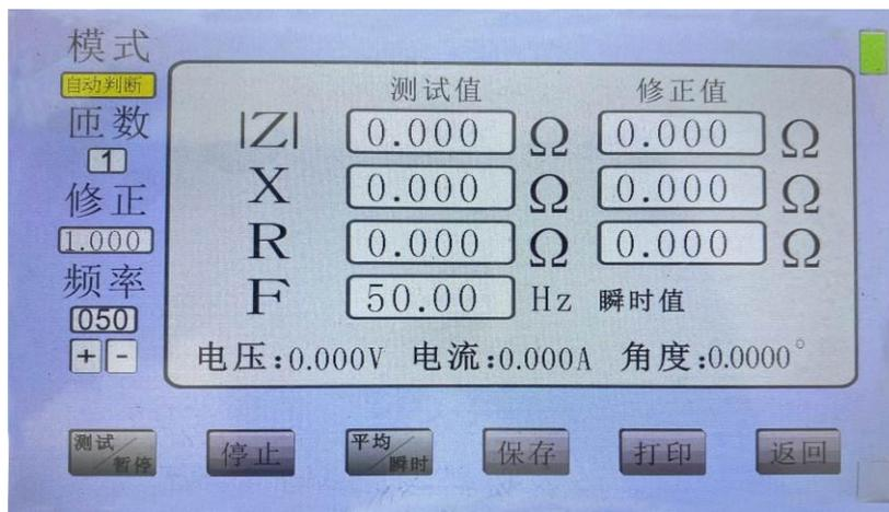
**模式** 为电流采样接入模式切换。共有3中模式。**直接采样**是:电流从电流接线柱输入。**罗氏线圈**是: 电流通过罗氏线圈(柔性电流钳)从外接CT端子输入。**钳形表**是: 电流通过钳形电流互感器从外接CT端子输入。**自动判断**是:由仪器自动判断电流以那种模式接入。
