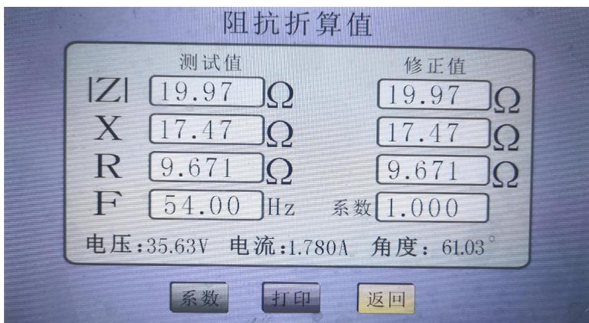
设置接地电阻的修正系数， 打印阻抗折算值。
