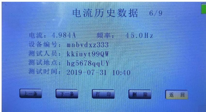
上一条 和 下一条 进行数据切换。打印 打印本条数据。
