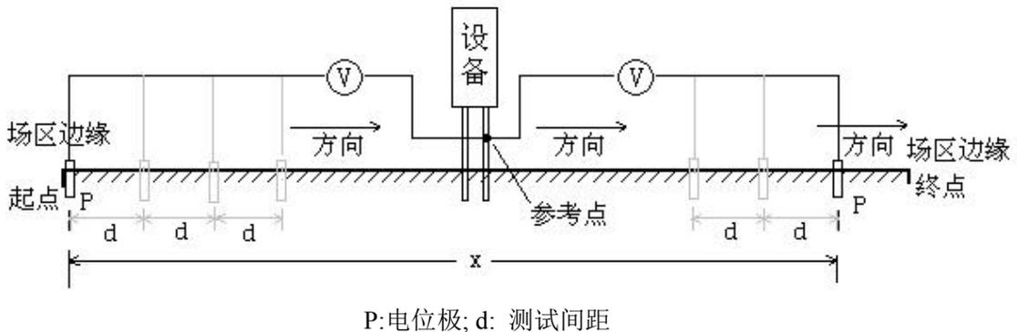
图 4-4 场区地表电位梯度分布测试示意图
