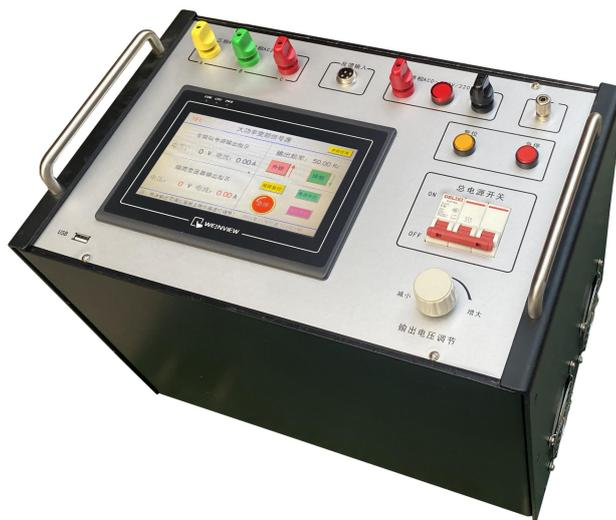
图3-1 大功率变频信号源前面板图
