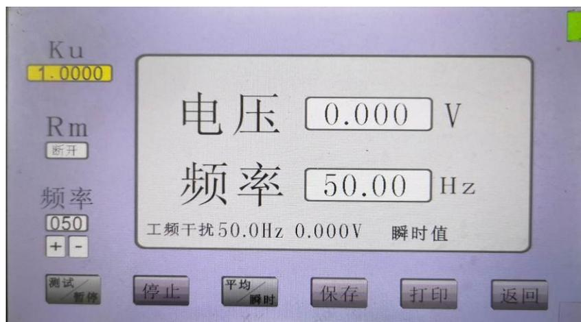
**Ku** 为外接电压互感器变比值，平时变比值为 1.0 。测试跨步电位差和接触电位差的
