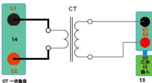
3. 接线图：图三 （二次回路接线图）
