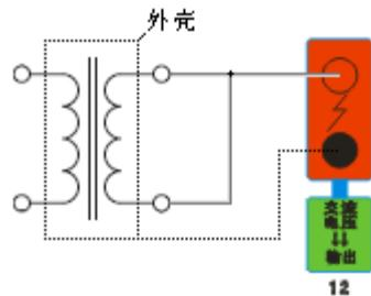
7. 接线图：图七（二次直阻接线图）
