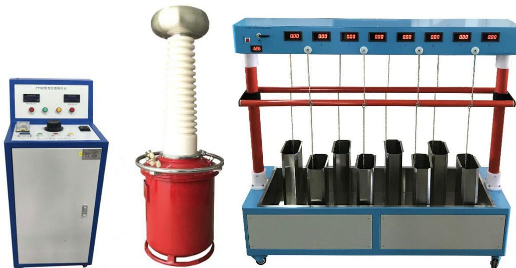
注：变压器为 10kVA/150kV 气变。控制台，试变通用。
