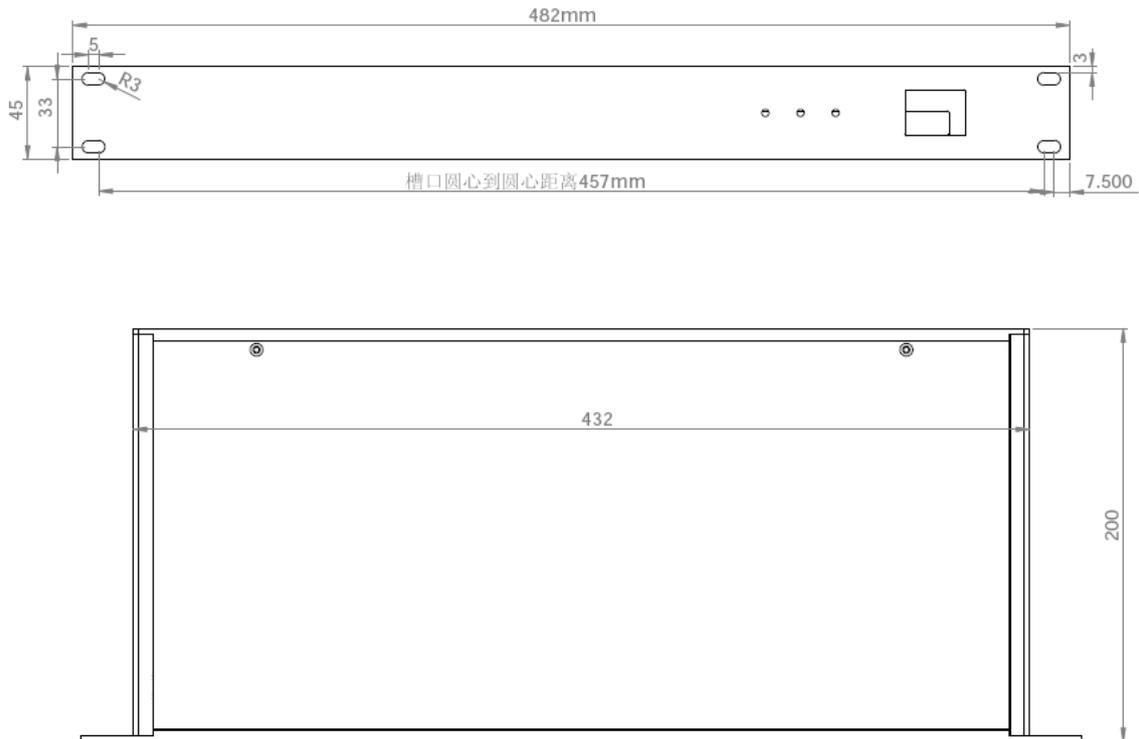
图 24 中心监控模块安装尺寸
