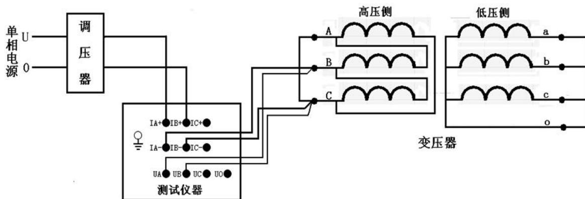
接好线后按“确认”键, 调节调压器给 BC 相加压 (如果采用仪器内电源作为测试电源则不需要连接调压器), 此时测量“BC”相的数据, 如下图所示:
