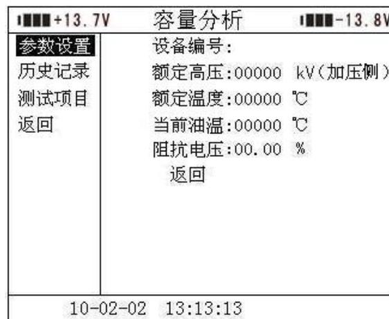
在测试之前，首先要进行相关的参数设置。光标指向“参数设置”项，此时按键盘上的“确认”键进入右边的参数设置，“↑”、“↓”键选择待修改的项，再按“确认”键进入待修改项的输入项，“←”、“→”键选择输入位置；“↑”、“↓”键改变当前光标所在位置数值的大小，“↑”键数值增大，“↓”键数值减小。
