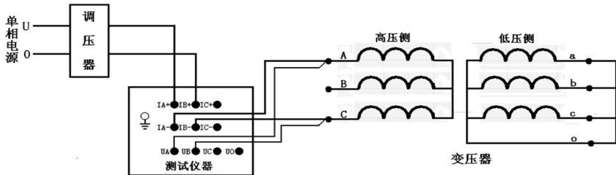
接好线后按确认键开始测量 CA 相，调节调压器给 CA 相加压，此时测量“CA”相的数据，如下图所示：
