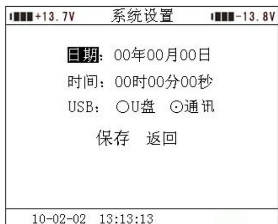
状态下，按“↑”、“↓”键来选择要修改的项目(如“日期”、“时间”、“USB”),选中后，按“确认”键进入数值修改(日期和时间)，“←”、“→”键选择需要校正的位置；“↑”、“↓”键改变当前光标所在位置数值的大小；“↑”键数值增大，“↓”键数值减小。USB模式通过“←”、“→”键来选择，U盘对应面板上的扁口USB座，只能插U盘用；通讯对应面板上的方口USB座，只能与上位机通信用；根据用户所需，选择不同的功能。设置完成后，直接保存返回。
