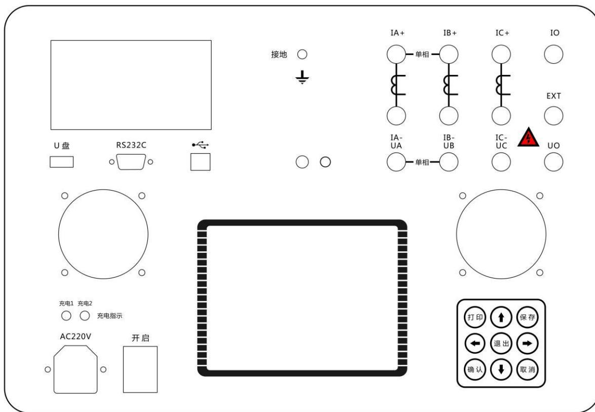
面板上从右到左，从上到下各部分分别是测试接线端子、接地柱、热敏打印机、AC 220V 电源插座、充电指示灯、电源开关、九芯串口座、液晶屏对比度调节旋钮、方口 USB 座、扁口 USB 座、键盘、液晶屏。
