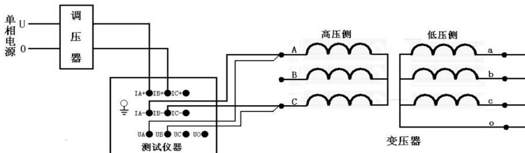
接好线后按“确认”键，调节调压器给 CA 相加压，此时测量“CA”相的数据，如下图所示：
