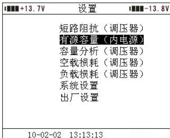
如果采用仪器外部调压器作为测试电源，则按“↑”、“↓”键选择下图“容量分析（调压器）”菜单再按确定。
