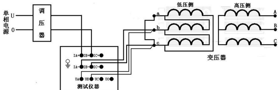
接好线后按“确认”键, 调节调压器给 bc 相加压, 此时测量“BC”相的数据, 如下图所示:
