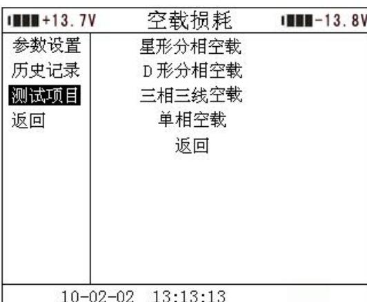
按“确认”键进入测试项目的选择，按“↓”键选择“三相三线空载”，按“确认”键进入测试界面，如下图所示：
