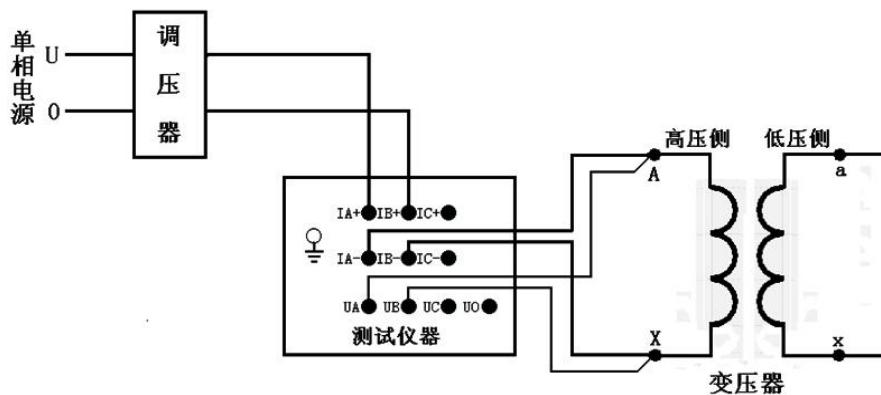
在容量测试界面下，设置好相关的参数后，选择“单相容量”，其测试界面如下图所示：
