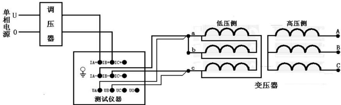
接好线后按“确认”键，调节调压器给 ca 相加压，此时测量“CA”相的数据，
