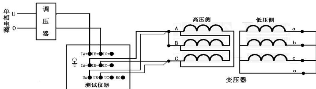
接好线后按“确认”键, 调节调压器给 CA 相加压 (如果采用仪器内电源作为测试电源则不需要连接调压器), 此时测量“CA”相的数据, 如下图所示:
