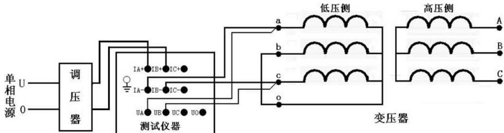
接好线后按“确认”键，调节调压器给 ca 相加压，此时测量“CA”相的数据，
