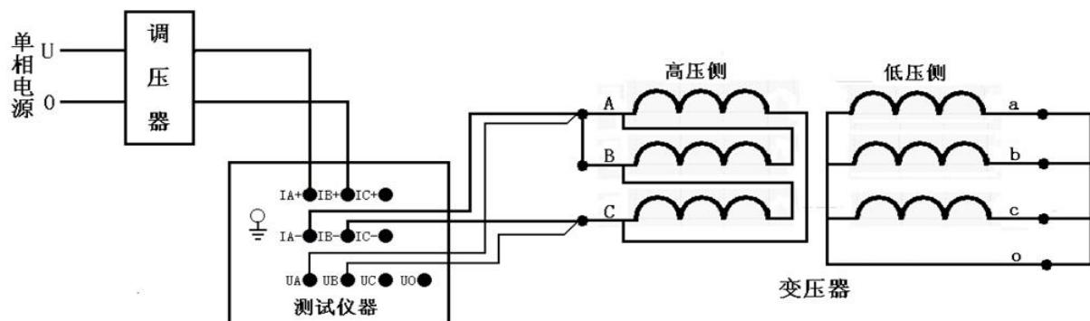
接好线后按“确认”键，调节调压器给 CA 相加压，此时测量“CA”相的数据，如下图所示：
