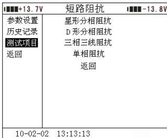
按“确认”键进入测试项目的选择，按“↓”键选择“三相三线阻抗”，按“确认”键进入测试界面，如下图所示：
