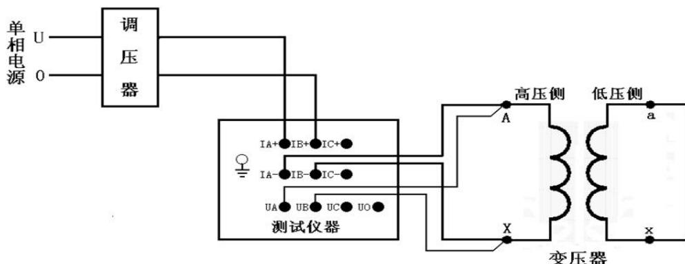
在阻抗测试界面下，设置好相关的参数后，选择“单相阻抗”，其测试界面如下图所示：
