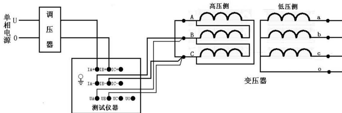
接好线后调节调压器给 BC 相加压，此时测量“BC”相的数据，如下图所示：
