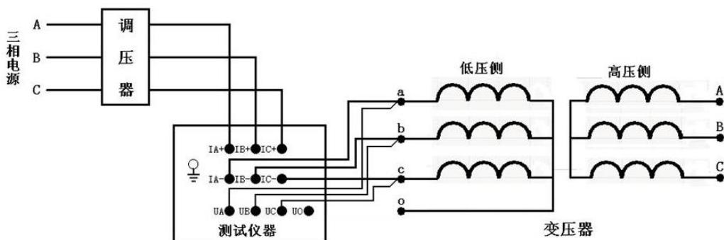
当测试电压、电流超过仪器测试范围时,需接电压互感器、电流互感器,接线方法如下图所示:
