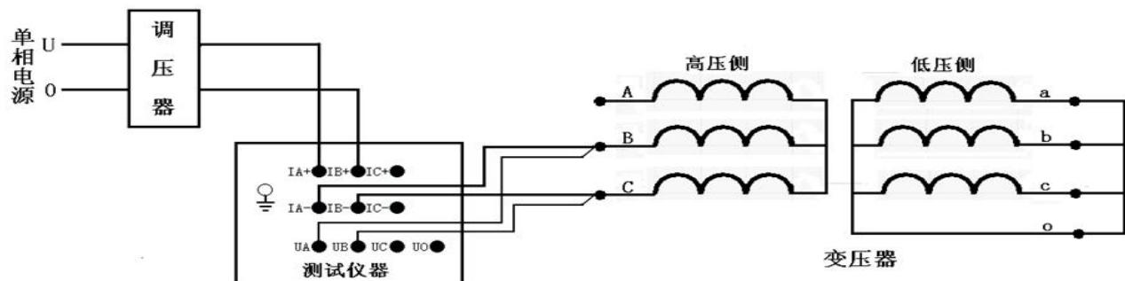
接好线后按“确认”键，调节调压器给 BC 相加压，此时测量“BC”相的数据，如下图所示：
