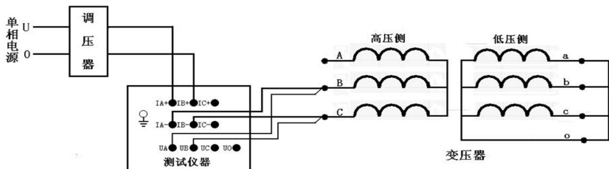
接好线后按“确认”键, 调节调压器给BC相加压(如果采用仪器内电源作为测试电源则不需要连接调压器), 此时测量“BC”相的数据, 如下图所示:
