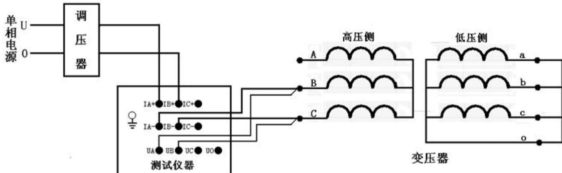
接好线后按确认键测量“BC”相的数据，此时，如下图所示：
