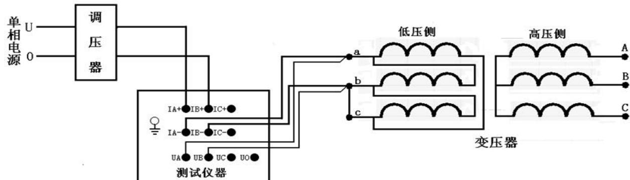
当测试电压、电流超过仪器测试范围时，需接电压互感器、电流互感器，接线方法如下图所示：
