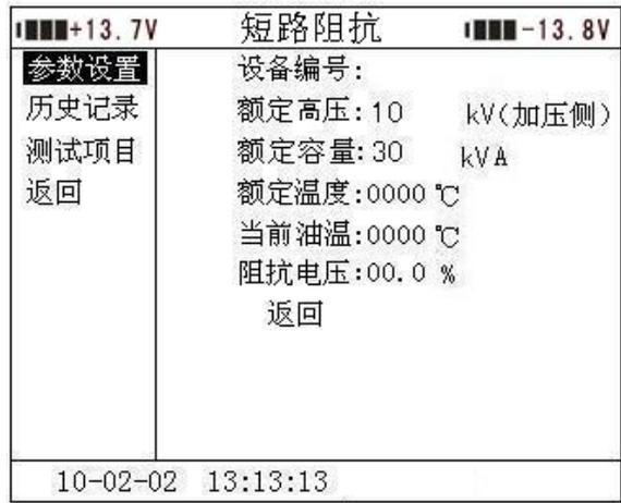
在测试之前，首先要进行相关的参数设置。在上图中光标指向“参数设置”项，此时按键盘上的“确认”键进入右边的参数设置，“↑”、“↓”键选择待修改的项，再按“确认”键进入待修改项的输入项，“←”、“→”键选择输入位置；“↑”、“↓”键改变当前光标所在位置数值的大小，“↑”键数值增大，“↓”键数值减小。
