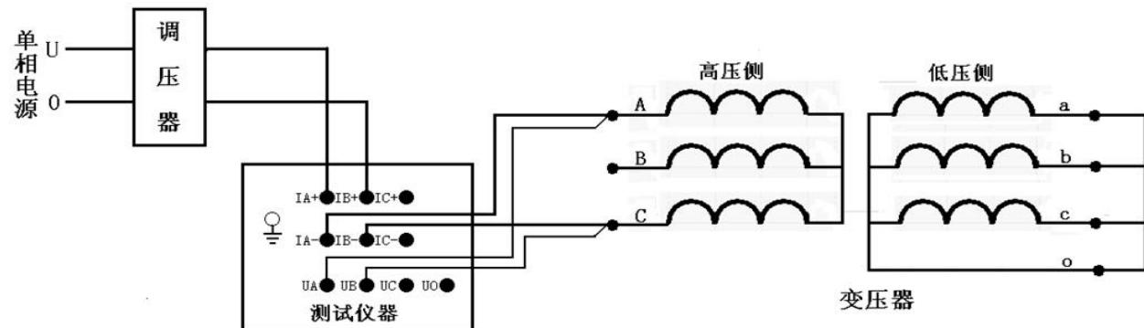
接好线后按“确认”键, 调节调压器给CA相加压(如果采用仪器内电源作为测试电源则不需要连接调压器), 此时测量“CA”相的数据,
