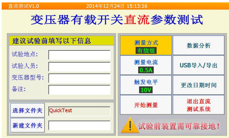
图 8-3 直流测试界面
