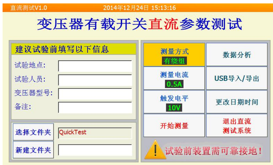
图 8-7 直流测试界面
