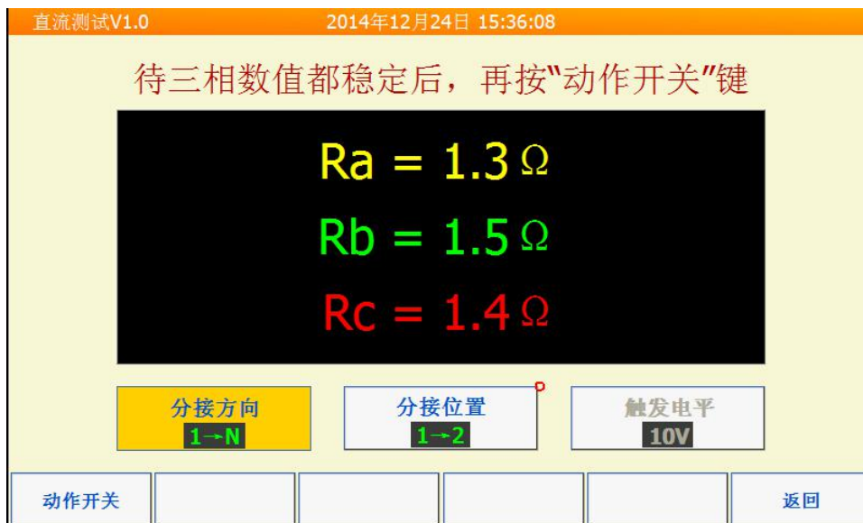
图 8-8 绕组电阻显示界面
