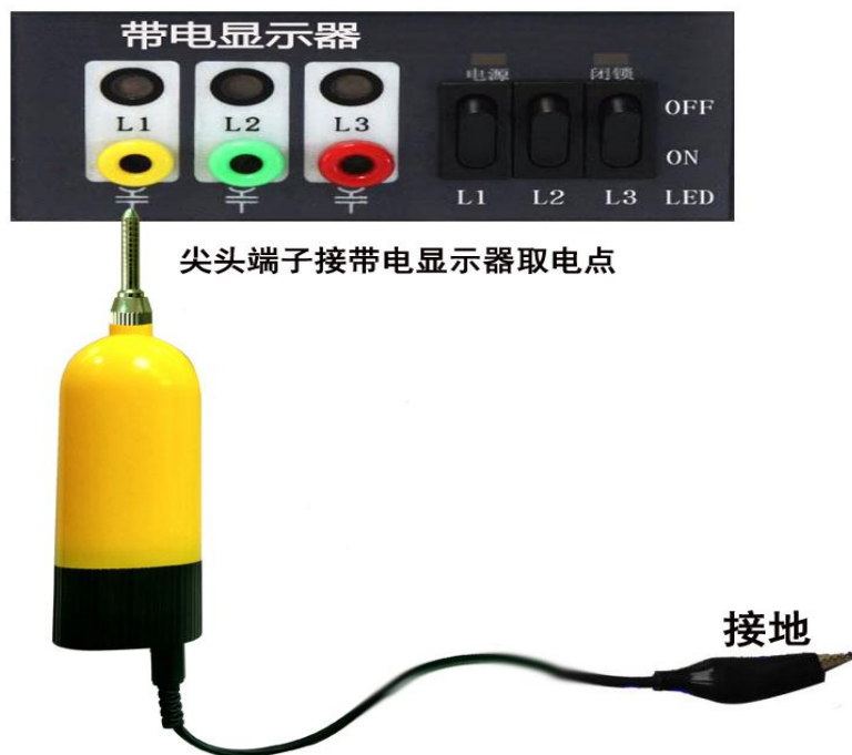
带电显示器核相示意图（图3）
