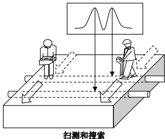
保持与发射机之间的距离在感应模式下，发射机除了给目标管线发射信号，还会向空气中发射信号，这可能会给在发射机附近的探测工作造成干扰。要检查接收机探测到的是管线的信号，而不是直接从发射机发射出来的信号，移动发射机一两米，如果管线也随之移动的话，这表明接收机离发射机的距离太近。另一种检查接收机是否接收到发射机信号的方法是把接收机指向发射机，如果接收机的响应大小不变或增加，说明接收机接收到的是直接从空中传播过来的发射机信号。在这种情况下降低发射机输出功率并降低接收机的灵敏度。接收机可能还要离开发射机25至30米。不要把发射机放在井盖上，因为这样会阻止信号到达管线。从目标管线感应到相邻管线的不需要的感应信号是管线探测中最常见的问题。这可能会导致目标管线的位置或深度测量不准确或探测到错误的管线。在许多情况下一定程度的感应
