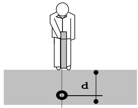
要获得高的精度，至少离开弯头5米处进行深度测量。当有较大的干扰源或存在相邻管线的感应信号干扰时，进行深度测量往往是得不到准确读数的。使用测量深度的功能时必须十分注意，因为干扰磁场和相邻管线对于直读测深的影响非常大。读深度值时操作者应首先探测干扰磁场和相邻管线的磁场，尽量在理想环境下测试深度。如直读法测深的精度不能满足要求。请使用45度角测试深度法或80%法。
