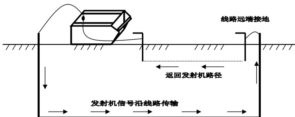
理解“回路”的概念很重要，管线定位仪的所有测试均需要所测地理电缆线具有良好的回路，若地理电缆线没有良好的回路就不会产生电流，没有电流就不会有电磁信号产生，没有电磁信号就不会在地面上接收到探测信号，因此就不可能探测到地下电缆。而对于运行电缆一般外铠已接地或零线接地自然形成回路，而对于非运行电缆则需特别注意。
