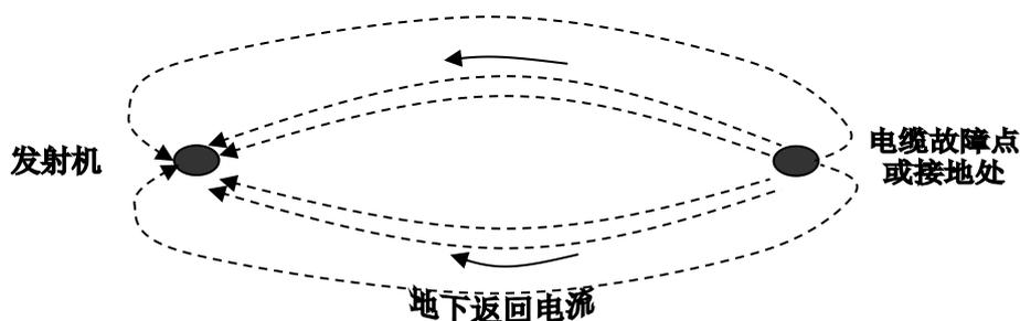
3、接收机可测试流过“A”字架的电流差值。使用“A”字架沿管线行走时，每隔三、四步插入一下“A”字架。开始时可将增益调大，当你逐渐接近故障点（电流高度集中的地域）时，接收机信号的读数会越来越高。这时需要调节增益键以减小接收机的灵敏度。如果信号开始增加，你的行走速度就应适当的放慢；并仔细检查地上的每一小段，以防止忽略故障点。接收机的读数将继续越来越高，直到有一探针跨过这个故障点。当故障点位于两针之间，电流会减小到读数接近零。调节增益键，使得读数保持为适当值，同时移动“A”字架，每次移动 10-30 厘米，一直到产生一个最低的读数。此时，故障点就位于“A”字架两探针之间（见下图）。
