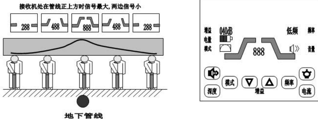
在测试时，峰值的读数可能会随着接收机同发射器之间距离的变大而缓慢减小，这是由于信号在电缆传播中可能有泄漏造成的。调节增益键，可以补偿信号的变化。如果接收机的读数忽然在急剧发生变化，这可能是由以下原因造成的：管线连接处（T 字接头），此时信号会沿着电缆朝多个方向传播；电缆的埋设深度有变化；电缆外皮受损接地；电缆盘园等。
