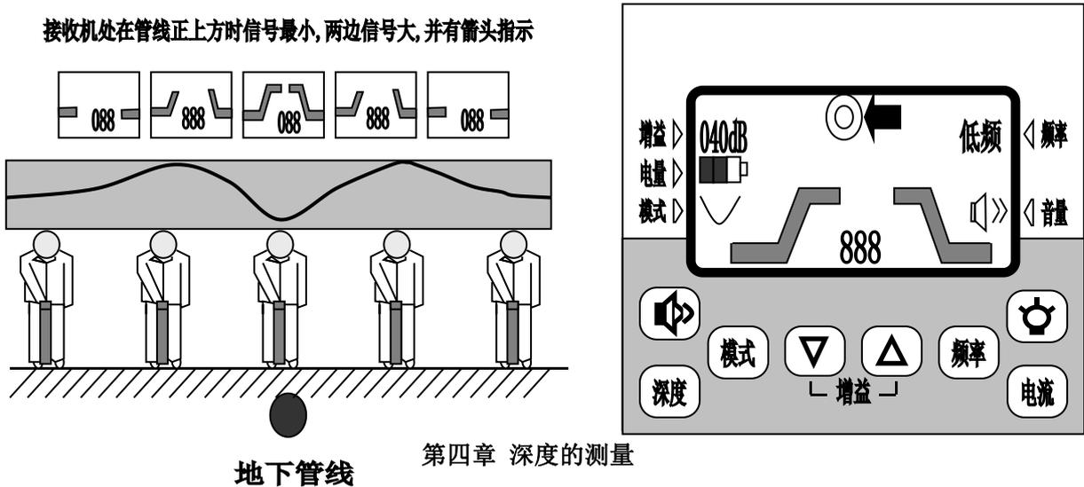
对电缆来说深度测量是一个比较重要的参数，本仪器提供了三种测量方法分别为直读法、45°法及80%法。几种方法各有优缺点，用户可根据不同使用环境、条件选择使用。下面分别介绍三种方法的使用。
