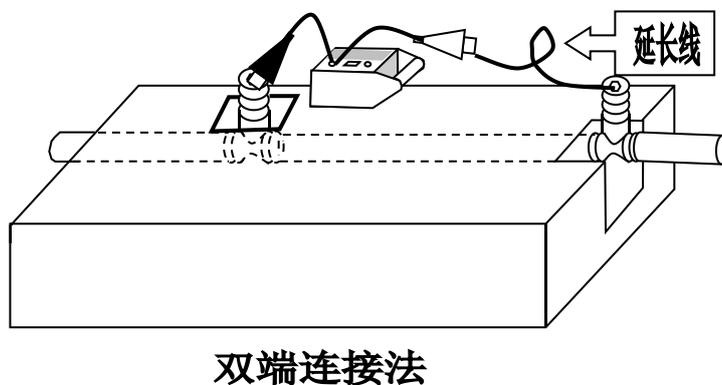
是不可避免的，但有经验的操作人员可以用一些方法减小感应的程度，从而提高探测的可靠性。尽量避免使用感应法施加信号。信号可能感应到下方的的多根管线上。可能的话尽量使用耦合夹钳。
