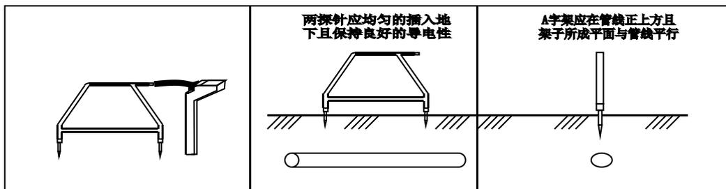
从故障点的流出的电流成轮辐状传导。在故障点附近土壤中的电流高度聚集开始传输，在接地棒（地钎）附近会聚。注意：接地棒（地钎）同故障点之间的电流分散的很开（见下图）。
