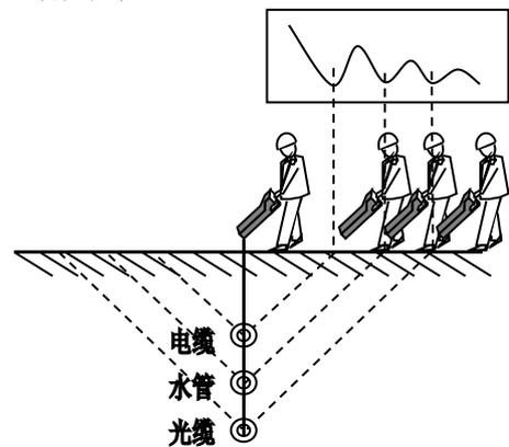
能感应到最浅的或导电性好管线上，在这种情况下用直读法测量时，可能测得深度不可信。
