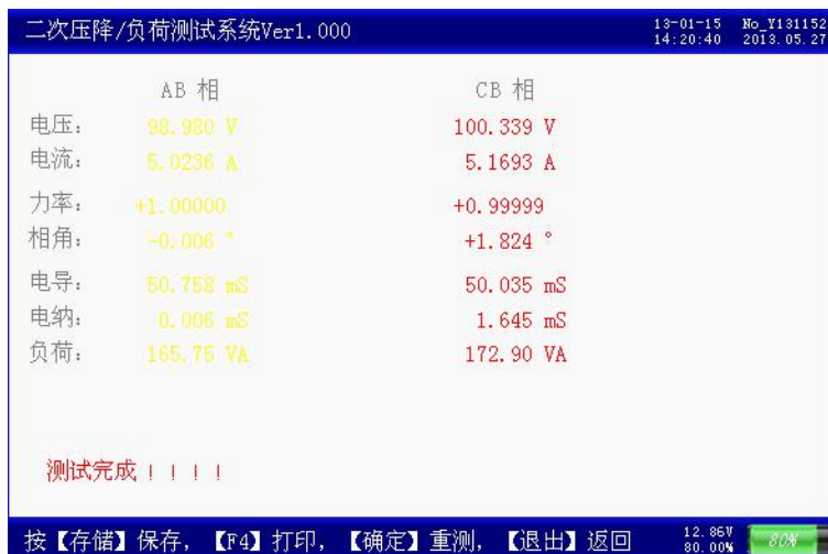
图十三 三线 PT 负荷测试 正常
