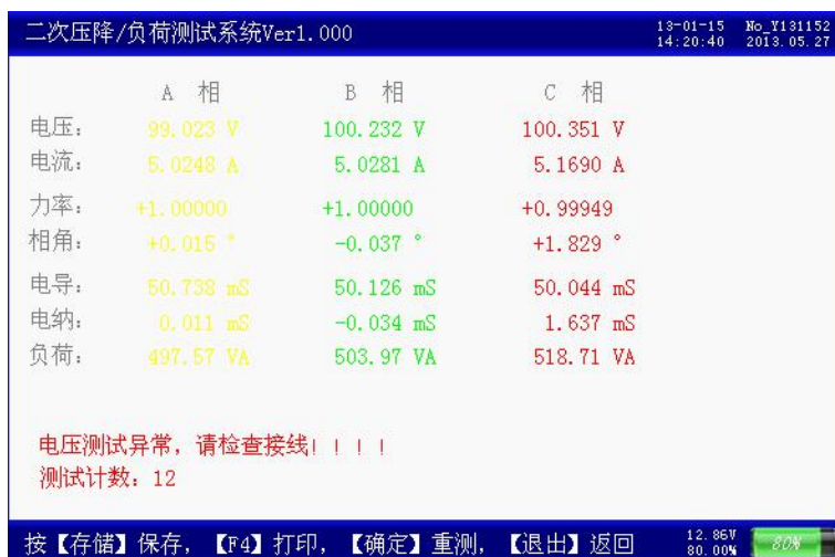
图十四 四线 PT 负荷测试 异常
