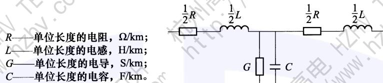
图A.1·一小段电缆的等效电路
