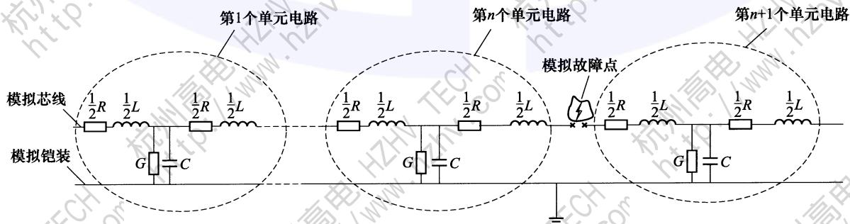
图A.3 模拟断线故障设置示意图
