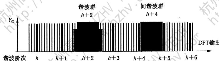
图 4 谐波群和间谐波群示意图(图示为 50 Hz 电源)
