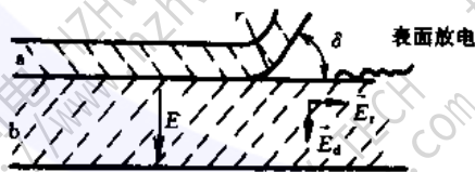
图 25-4 介质表面出现的局部放电
